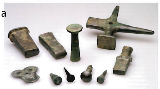
Nástroje používané při tepání výrobků z bronzu: kovadlinky, kladívko, průbojníky aj.
